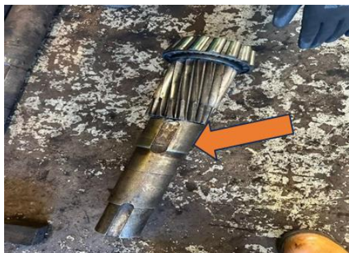
Gambar 5. Shaft Mengalami Kegagalan Patah
