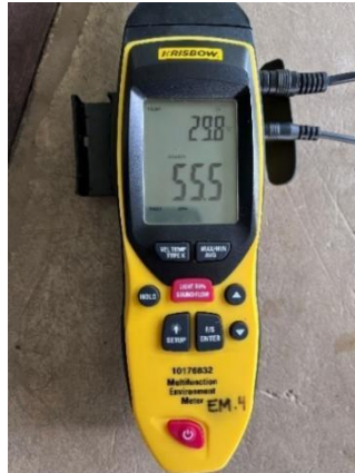
Gambar 1. Pengukur Lingkungan 5 In 1 Untuk Suhu, Kelembapan, Suara, Cahaya, Dan Aliran Udara
